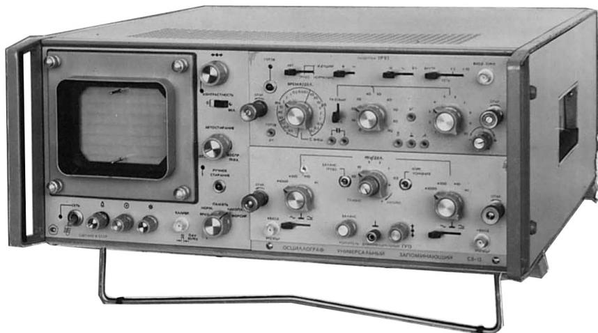
Запоминающий осциллограф со сменными блоками С8-13. 1974 г.
