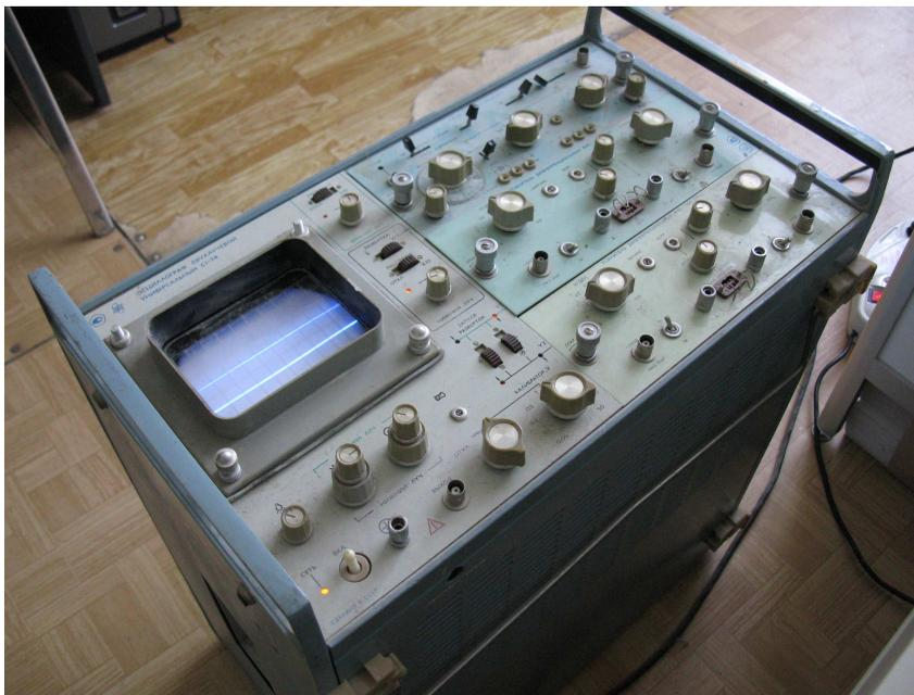
Двухлучевой осциллограф со сменными блоками С1-74. 1974 г.
