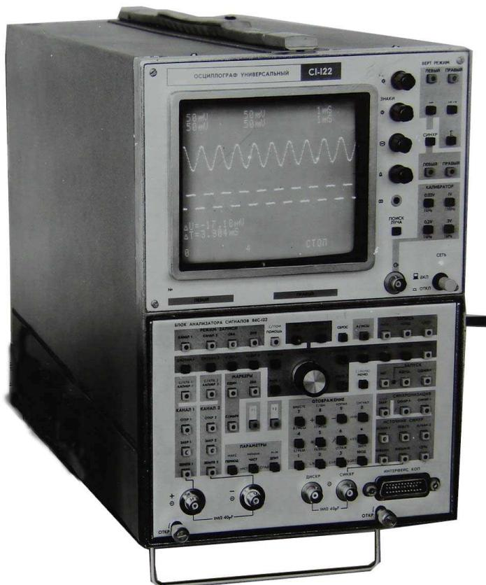
Универсальный осциллограф со сменными блоками С1-122 с полосой пропускания 0 - 100 МГц и блоком анализатора сигналов Я4С-122. 1986 г.
