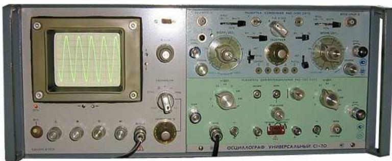
Универсальный осциллограф С1-70 с блоками усилителя 1У11 и развертки 1Р11. 1972 г.
