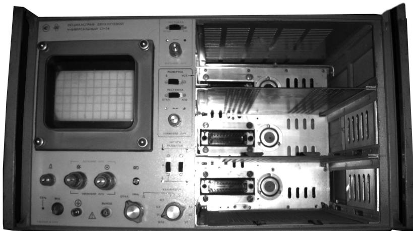
Фотография базового блока осциллографа С1-74 без вставленных сменных блоков
