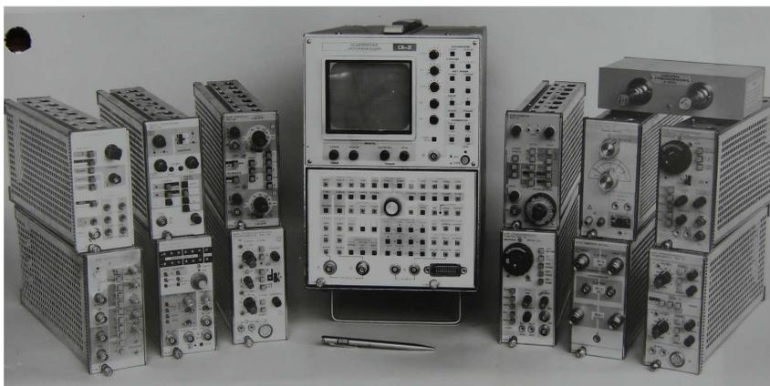
Запоминающий осциллограф со сменными блоками С8-21. 1987 г.
