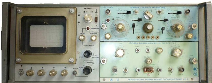
Запоминающий осциллограф со сменными блоками С8-12. 1974 г.
